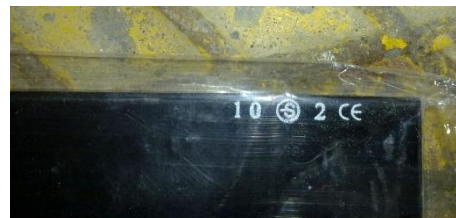
Particolare della marcatura del vetro inattinico protezione DIN 10
